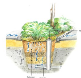
Esimerkkikuvia hulevesien käsittelyrakenteista (Kuvat ylhäältä alas oikealle: Uponor, Rudus ja Ramboll Taru Mäkiranta)
